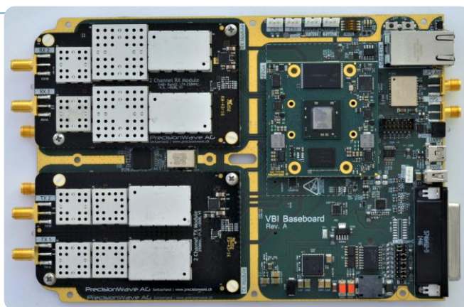
Modulare, breitbandige RF-Schnittstellen (bis zu 150 MHz RX- und 600 MHz TX-Bandbreite) machen unser System für Sie maßgeschneiderte Frequenzanforderungen bereit. Kontaktieren Sie uns mit Ihren Spezifikationen.
