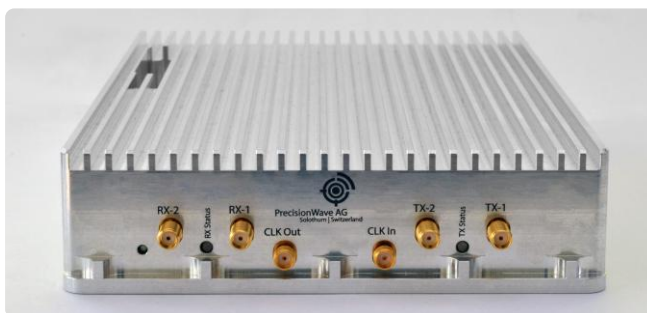
HF-Schnittstelle am Modul: dualer RF-Eingang, Taktung und dualer RF-Ausgang. Zum Beispiel erlaubt unsere Hardware auch den unabhängigen Betrieb von zwei Tunnelröhren.
